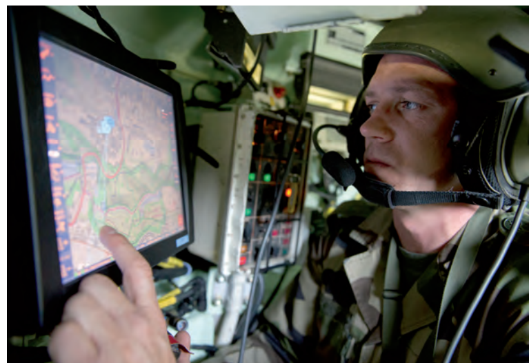
Le chef de section est sur le terminal d'accueil du logiciel opérationnel de conduite au combat dans un AMX 10 RC.
