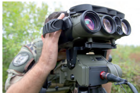
Utilisation d'une jumelle infrarouge multifonctions long range (JIM LR) posée sur une plate-forme motorisée et télécommandable fixée sur trépied.
